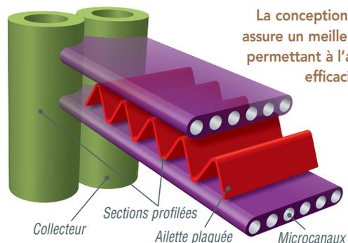
La conception originale du serpentin assure un meilleur échange thermique, permettant à l'appareil de fournir une efficacité de plus de 13 TRÉS dans un espace réduit.
